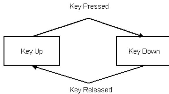
Fig. 3.4.2: PianoKey State Diagram
