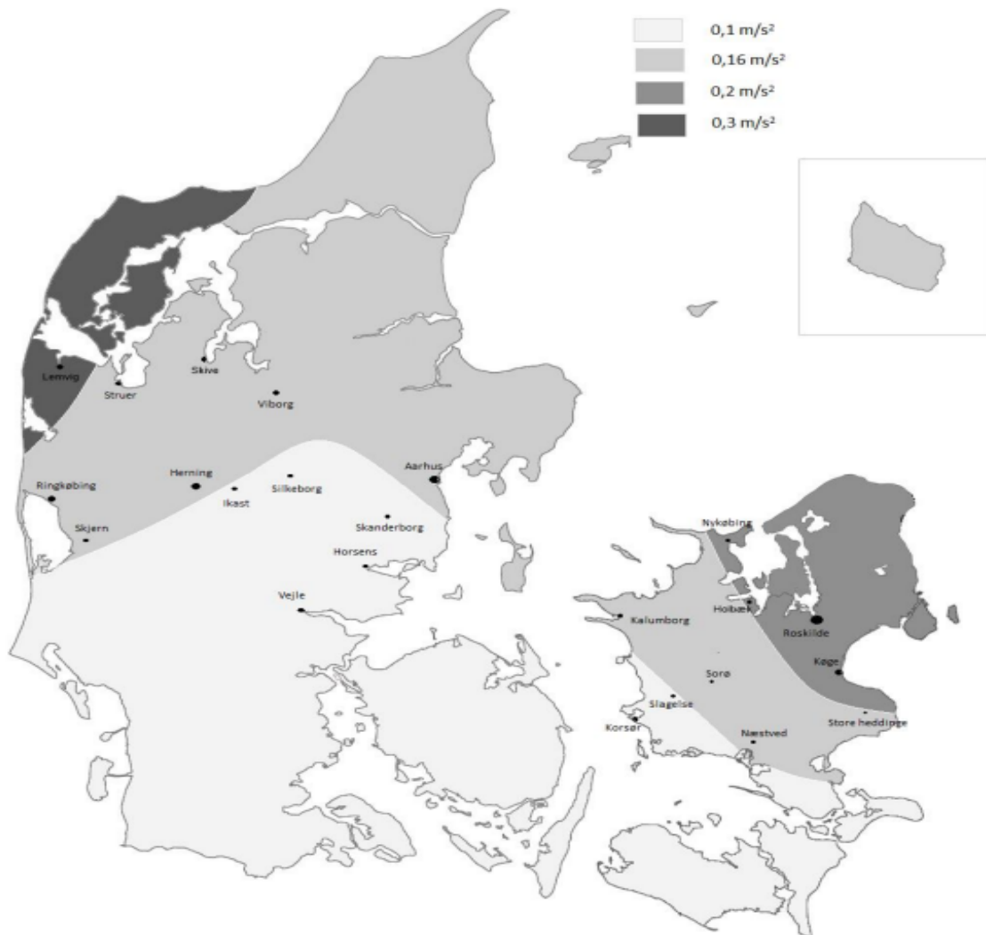
Figur 3.22 Værdier af regningsmæssig grundacceleration i Danmark. [27]
