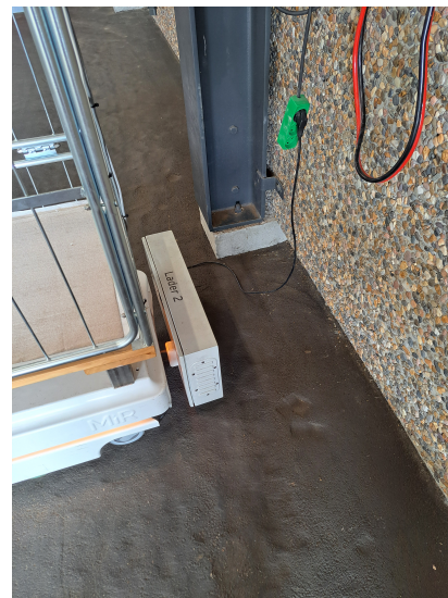
Figur 4.13. Robotten og ladestanderen set ovenfra.
