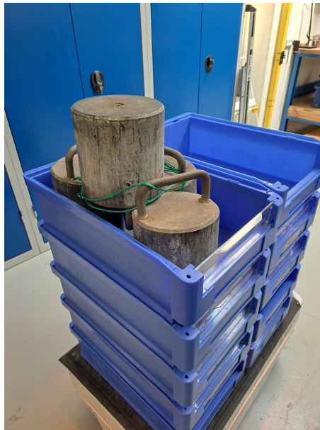
Figur 4.1. 110 kg last hvor de 100 kg er placeret i øverste kasse til venstre og de resterende 10 kg kommer fra kasserne.
