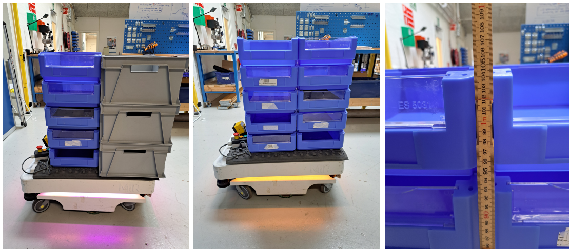
Figur 3.1. Venstre: 5 blå kasser + 3 grå. Midten: 2 x 5 blå kasser. Højre: Kasser + robot måler 105 cm
