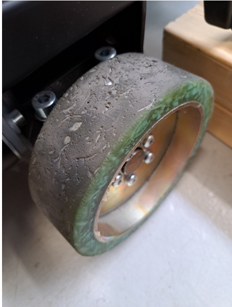
(a) Gammelt "drivewheel" med mange fordybninger og meget støv. (Venstre)
