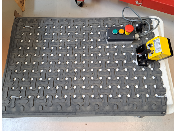
Figur 7.5. Skridsikker måtte som sørger for at lasten ikke skrider af robotten.
