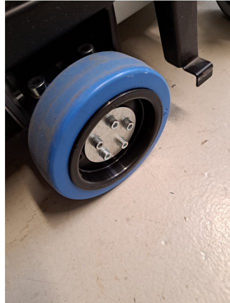
(b) Nyt drivewheel uden fordybninger og minimalt støv. (Højre)
