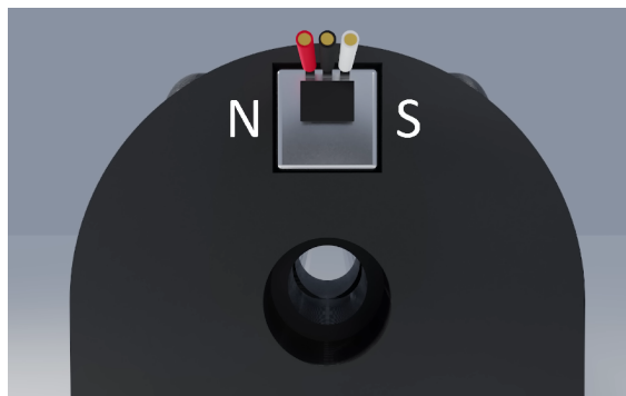
Figure 3.13. Hall effekt med magnet[15]
