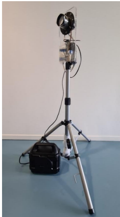
Figur 7: Luftpumpe bestående af en centrifugalblæser fikseret til en plexiglasplade og drevet af et batteri.
