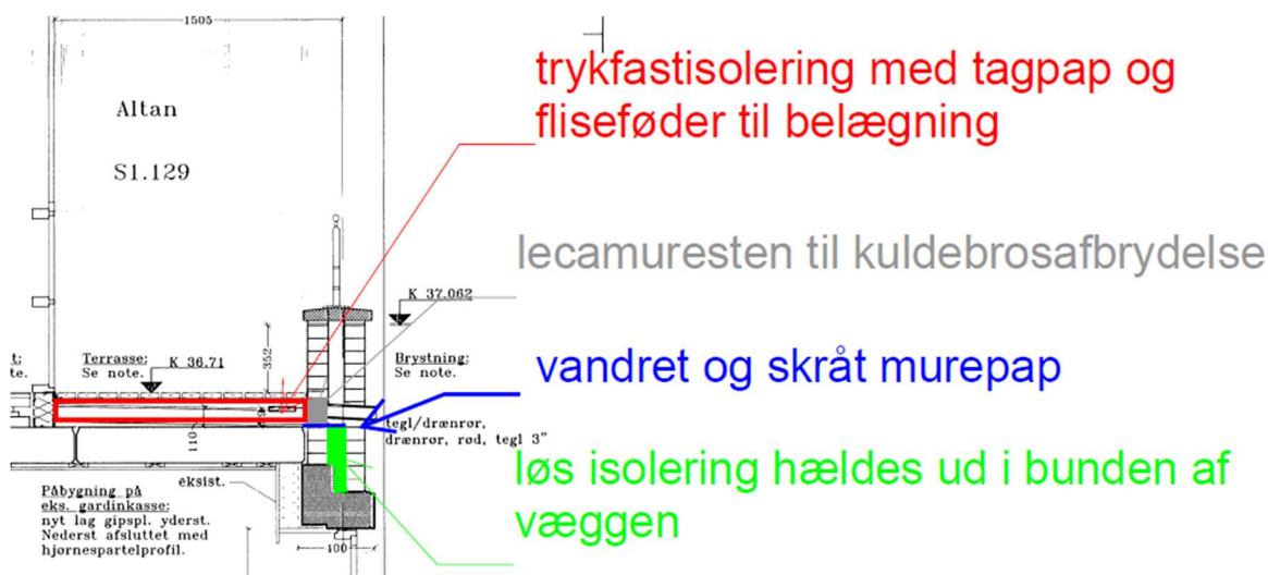
Figur 48- Løsning af kuldebrosproblematik.
