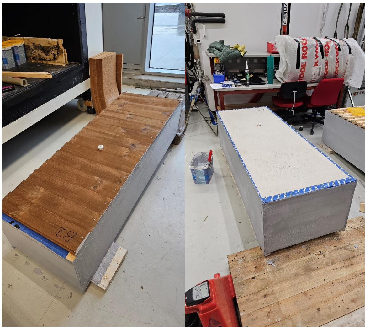
Figur 16 - Hotbox/coldbox-forsøg: Testelementer med vådrumsforsegling og tapet samlinger (Rasmussen, T. V. personlig kommunikation, 10. april 2025).
