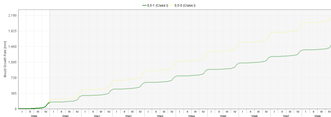
Figur 30 - Mycelievækst i vurderingspunktet bag vindspærren. AMOC-scenarie (2089–2099). Konstruktion med mineraluldsisolering, U = 0,10 \text{ W} / \text{m}^2 \text{K} . Vindspærre med Z = 0,5 \text{ GPa} \cdot \text{s} \cdot \text{m}^2 / \text{kg} . Kurverne viser tæthedsplan med Z = 0 og 1 \text{ GPa} \cdot \text{s} \cdot \text{m}^2 / \text{kg} .
