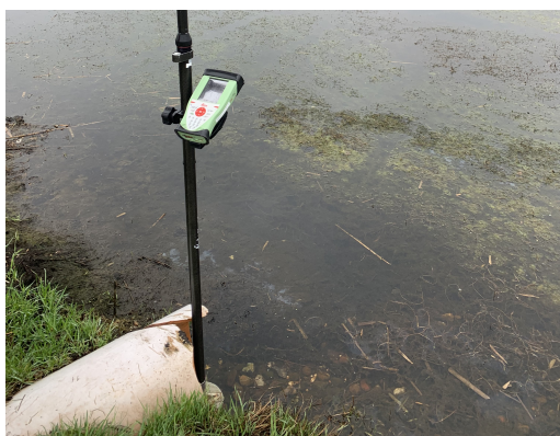
Figur 4.6. GPS opmåling af rør mellem Frejlev Skolevej Bassin og tørt bassin. Billeder taget 23/04/2025.
