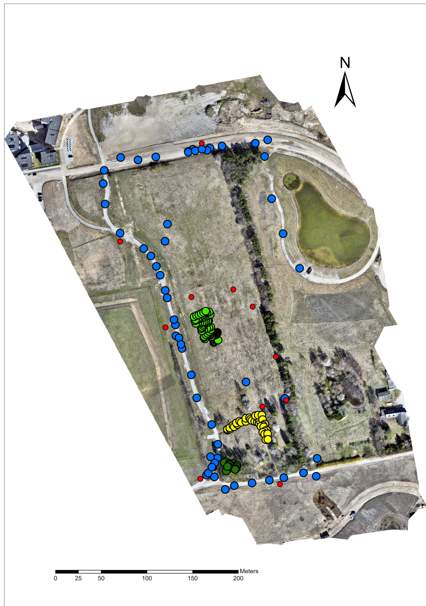
Figur 8.11. Fordeling af kontrol, TS-fiks og terrænpunkter i projektområdet. Kontrolpunkterne er angivet med blå farve, mens terrænpunkterne er angivet med deres respektive farve jf. figur 7.1. TS-fikspunkterne er angivet med røde punkter, hvor punktet nord for de gule punkter er TS opstillingen jf. figur 8.9. Figuren er i fuld størrelse på bilag F.
