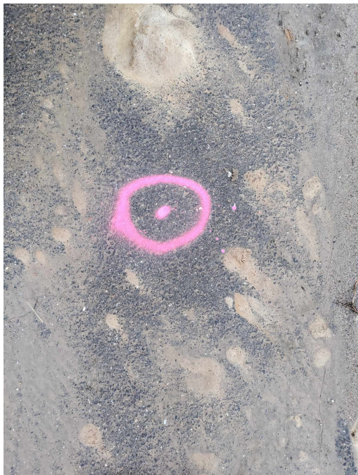
Figur 8.1. Eksempel på et kontrolpunkt, spraymalet på asfalt, som i dette forsøg bliver benyttet til at identificere hvor henne tidligere målinger er blevet foretaget, med henblik på gentagende målinger af det samme punkt.
