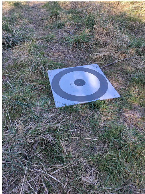
Figur 8.2. Billede af de targets, som blev lagt ud i projektområdet. Targets kan identificeres på det digitale orthofoto, hvor forskydningerne kan undersøges. I dette projekt bliver targets benyttet kontrolpunkter
