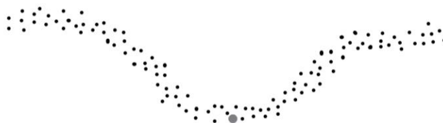
Figur 28 – Illustration af skæringsprofil med terrænpunkter. Sort: DTM. Lys grå: vandløbsmidten.
