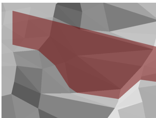
Figur 30 - Illustration af et lodret skæringsplan, der skærer TIN-modellen. Set i perspektiv. Rød: skæringsplan. Grå trekant: TIN-modellen.
