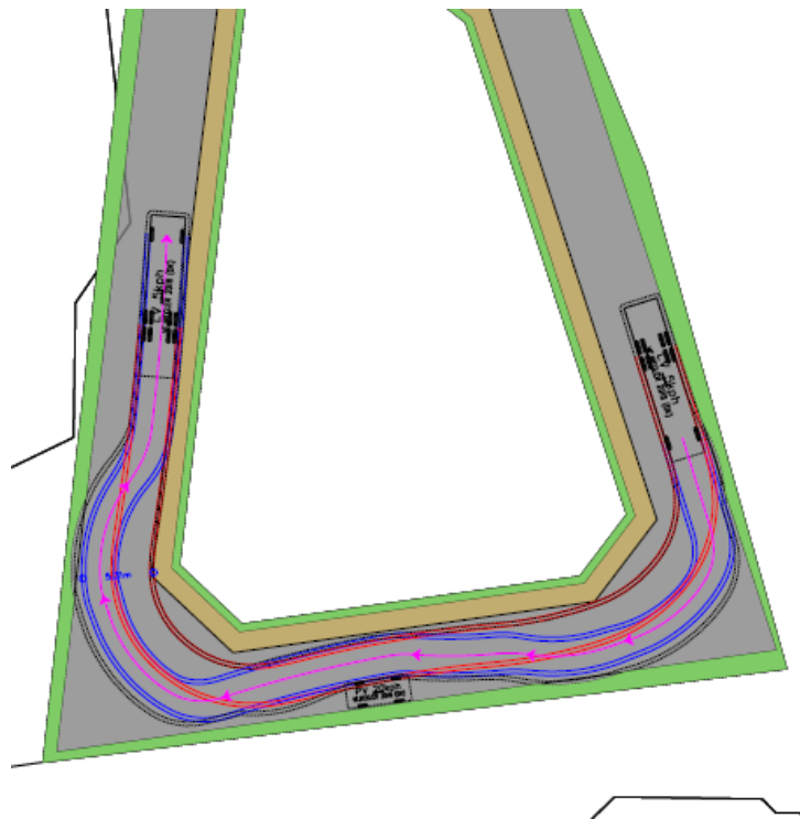
Figur 8.4 Skitse af kørekurver for rundingen på den oprindelige udstykningsplan.
