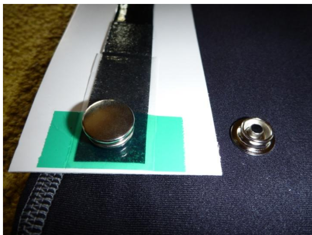
Fig. 1: Her ses et af trykknapsystemerne tæt på. Det er endnu ikke monteret, men placeret, hvor det forventes isat.
