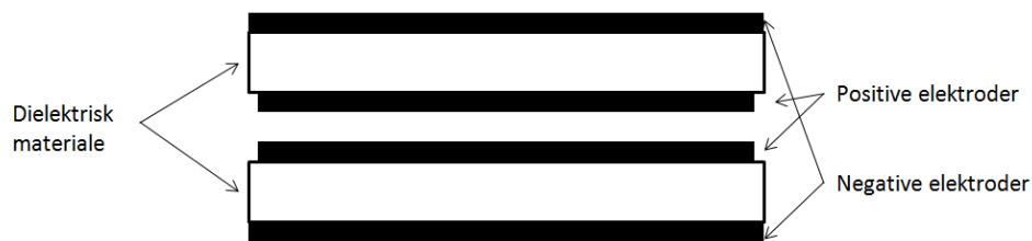
Fig. 3: Sensormaterialets opbygning, med de negative elektroder yderst og de positive elektroder inderst. Det kan ses, at længden af de positive elektroder er lidt kortere end materialet, hvilket er med til at beskytte de positive elektroder fra omverdenen. Kapacitansen måles som et gennemsnit af de to elektriske feltstyrker.
