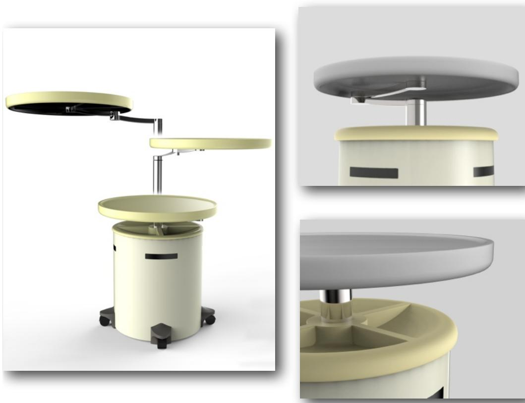
Fig 15: 3D renderinger af Jeeves. Billedet til venstre skal illustrere, hvordan bakken kan hæves og sænkes. De mørke paneler på robottens krop viser hvor Kinect-kameraet skal kunne se ud på omgivelserne, så robotten kan navigere. 3D renderinger: Anders Klitgaard
