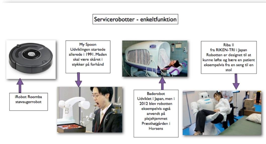
Fig 7: Serviceroboter med én funktion. Denne type af robotter er designet med fokus på en enkelt funktion, som afspejles i udformningen af robotten.
