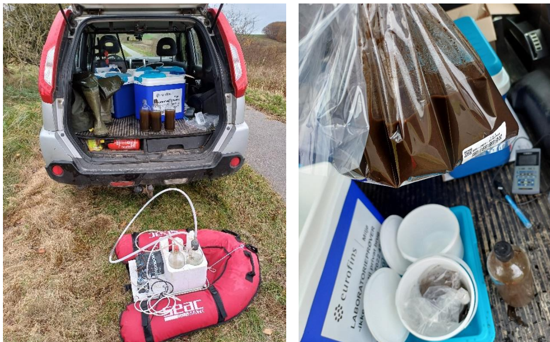
Figur 6: Billeder af prøvetagnings udstyr på en af stationerne i MFS programmet. Billede til venstre viser sediment pumpen og båden. Billede til højre viser det indsamlede sediment i en rilsan pose.
