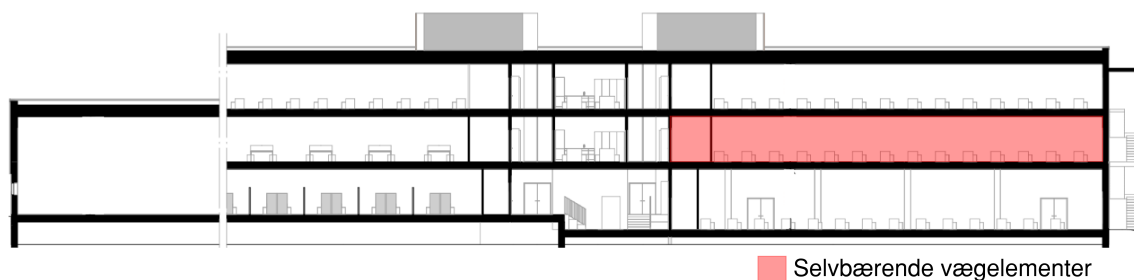
Figur 3.22 Angivelse af de selv bærende vægelementer for hovedkonstruktionen. Udklip fra IFC model. IFC-model udleveret af DS Flexhal
