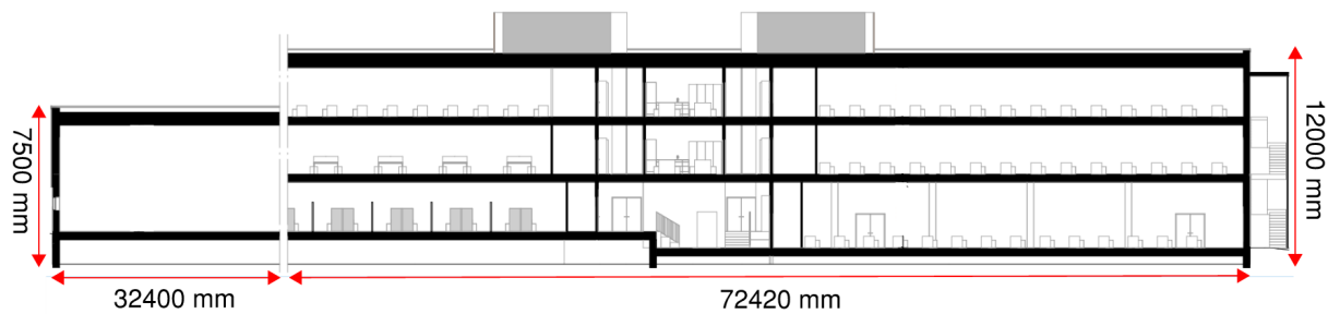
Figur 2.6 Længdesnit af bygværket. [Forskningsfondens Ejendomsselskab, P+P arkitekter, 2023]
