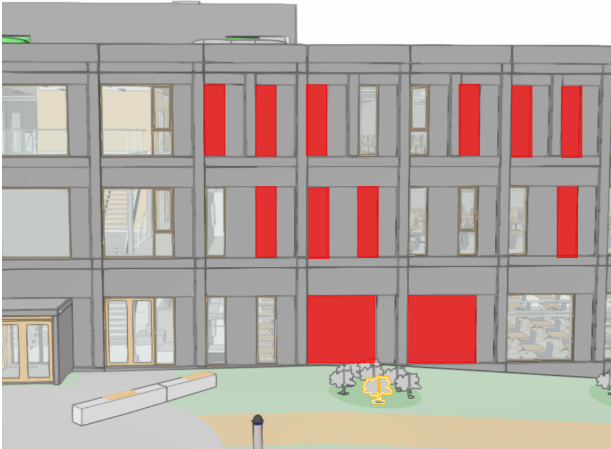
Figur 2.10 Områderne hvor der er forberedt til potentielle udsparringer er markeret med rød. I disse områder er forpladen tyndere end den er for resten af elementet. IFC-model udleveret af DS Flexhal
