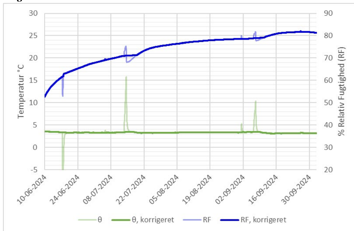
Figur 42. Målte temperaturer (grønne kurver) og relative fugtigheder (blå kurver) i målepunktet bag vindspærrepladen i væg 1. Kurverne udtrykker middelværdierne af måledata fra tre sensorer i midten af væggen. Grafen viser både måledata med fluktuationer samt korrigerede kurver, som er beregnet ved interpolering. Det ses, at den midlede relative fugtighed overskrider 75 % efter omtrent halvanden måned. Temperaturkurven uden for skalaen nåede -10 °C.
