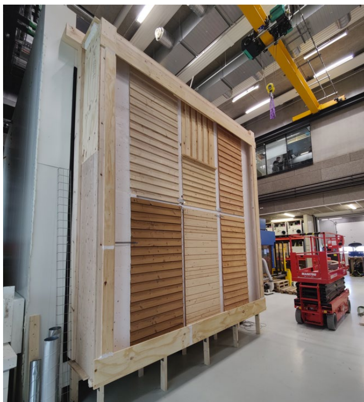
Figur 17. Foto af testopstillingen. Billedet viser de sammenbyggede vægge opbygget mod hotboxens varme side. Det kolde kammer blev derefter placeret op imod den fugede krydsfinerramme.
