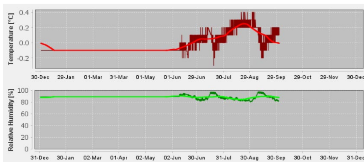
Figur 27. Udklip fra opsætning af væg 1 i WUFI. Graferne angiver hhv. temperatur og relativ fugtighed i det kolde kammer - i WUFI svarende til Outdoor Climate . De mørke kurver modsvarer de tilpassede måledata fra væggenes overfladesensorer. Kurvernes tidsstempel er identisk med den justerede måleperiode fra d. 10. juni til d. 3. oktober beskrevet under kap. 5.4.3 Datahåndtering og -udvælgelse .
