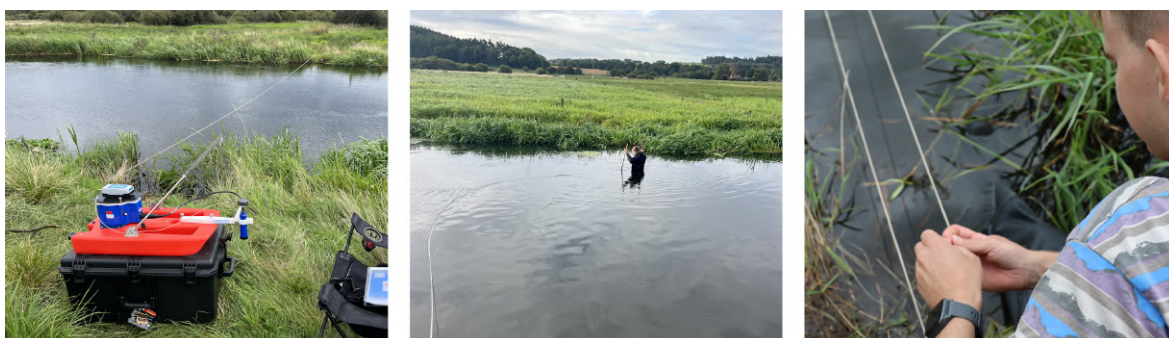
Figur F.5: Opsætning af ADCP ved Vejrumbro (august 2023).
