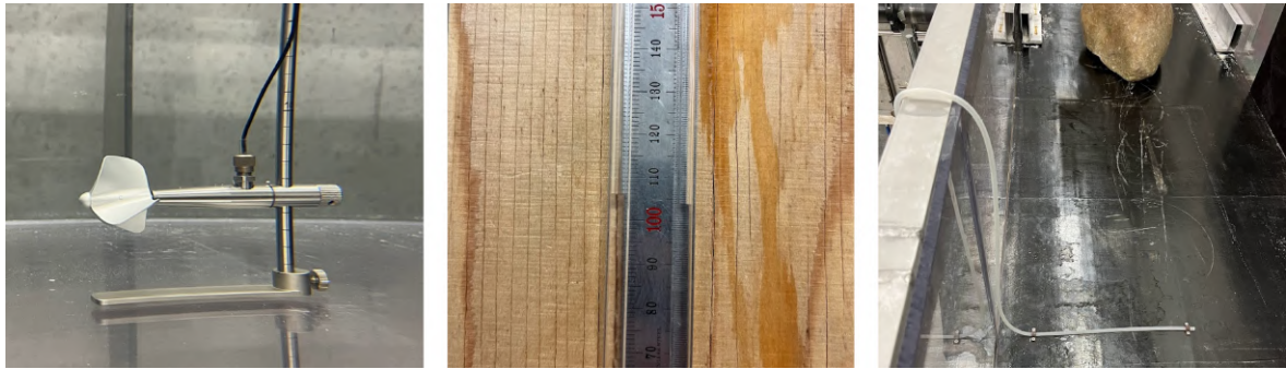
Figur 8.4: Billede af vingemåler (model OTT C2), tryktabsmanometer og hævert slange.
