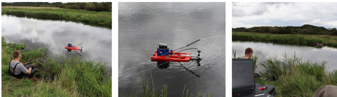
Figur F.4: Billeder af udførelse ADCP målinger ude for Vejrumbro (august 2023).
