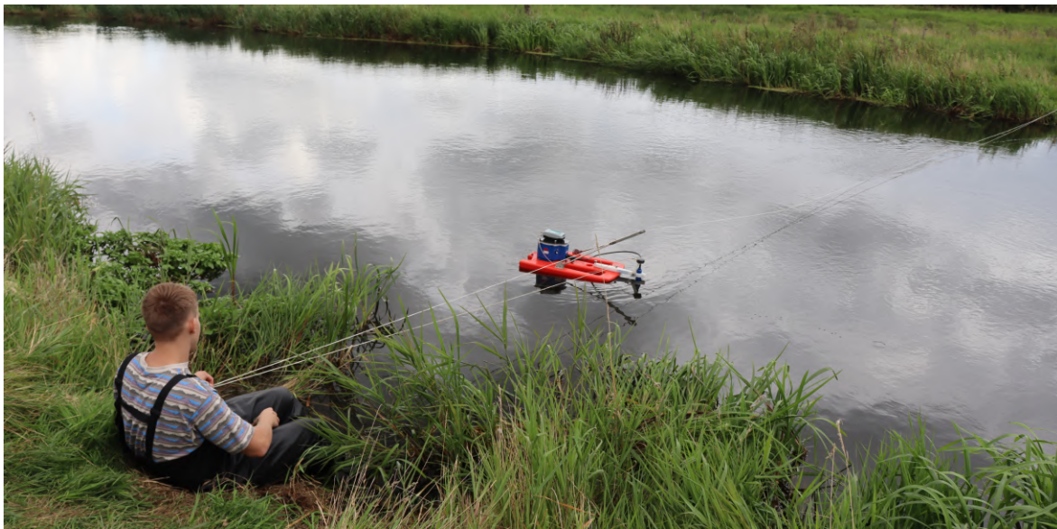
Figur 5.1: Udførelse af dopplermåling i Nørreå. Billedet er taget den 23. august 2023.
