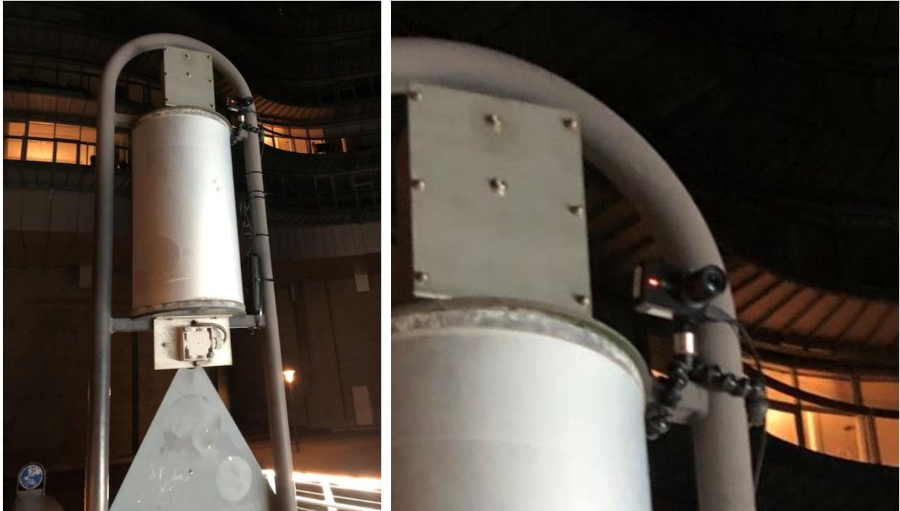
Figur 8 – Videoopsætning på Bryggebroen. Kameraet blev monteret på en skiltestander og optog det samme tværsnit af cykelstien fra den samme vinkel som i Trafitecs undersøgelse.
