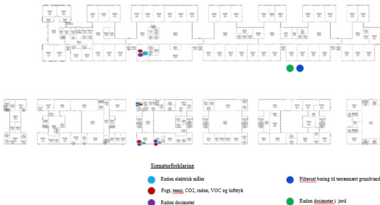
Figur 83 – Placering af målere i stueplan samt placering af radonmåling i jord og kort filtersat boring.
