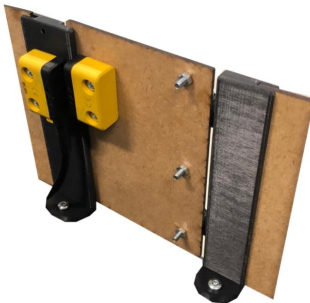
Figur 40 Figuren viser en dør i prototypens sikkerhedsafskærmning. De studerende vil kunne manipulere med denne, ved at betjene døren, tilslutte og afprøve kontakten på døren. En løsning som vil sikre hurtig feedback
