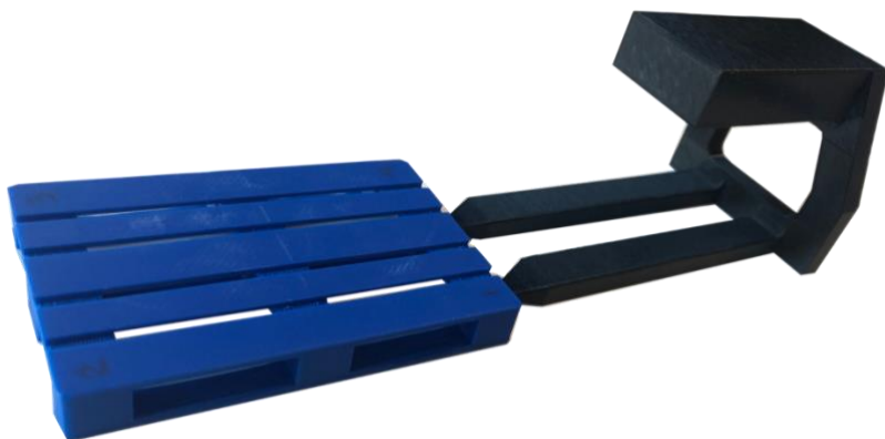
Figur 23 Billedet viser en blå europapalle og løfteåget som er designet til cobotten.
