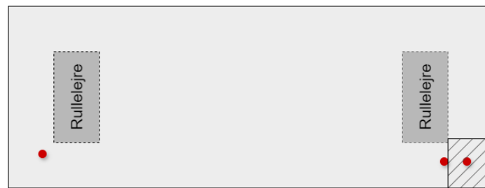
Figure 7.3. Skitse af opstillingsmuligheder, eksempel fra pille 1. Opstillingen bør placeres i det skraverede område.
