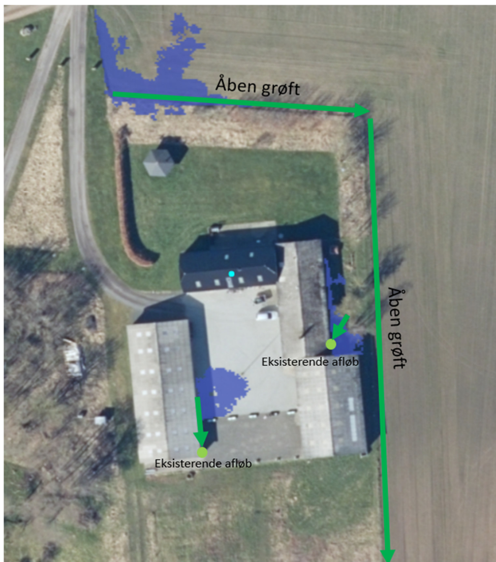
Figur 75 Forslag til afledning af overfladevand
