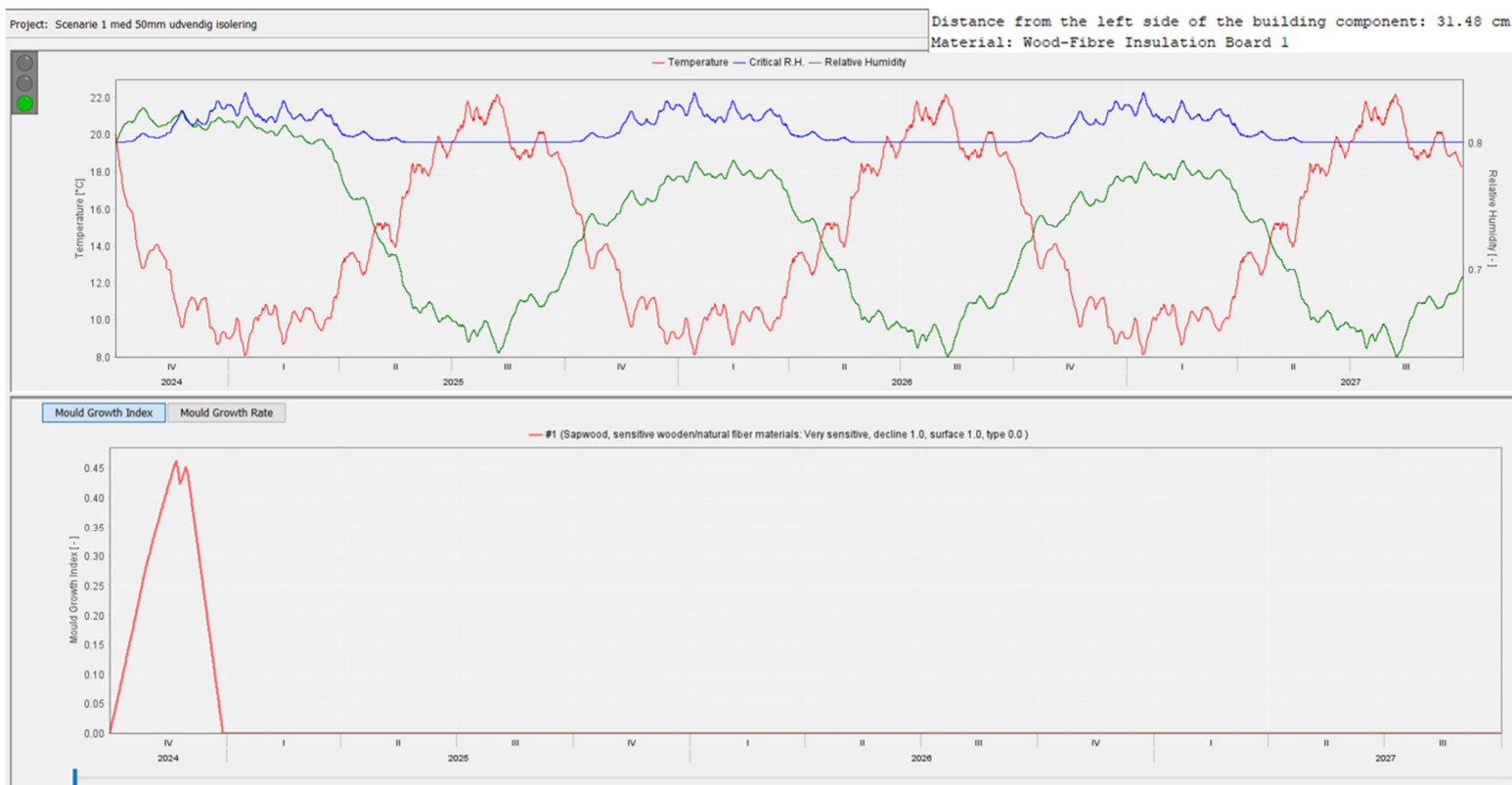
Figur 80 VTT-beregning med 50mm udvendig isolering
