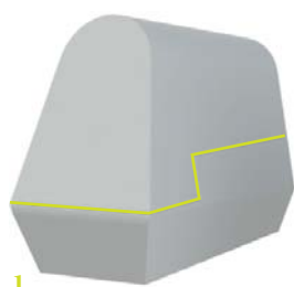
1 Formen splittes op i to dele; en doseringsenhed og et medicinlager
