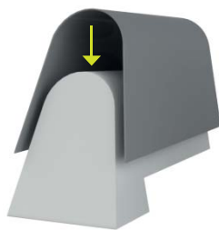
2 Den øvre del omkranses af en yderdel, så den har en jævn bund og derved kan stå separat
