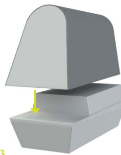
3 Produktets inder- og yderdele passer sammen, hvilket gør at de både kan stå separat og samlet
