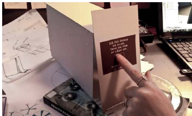
Gennem forsøg er displayets vinkel bestemt til 20°
