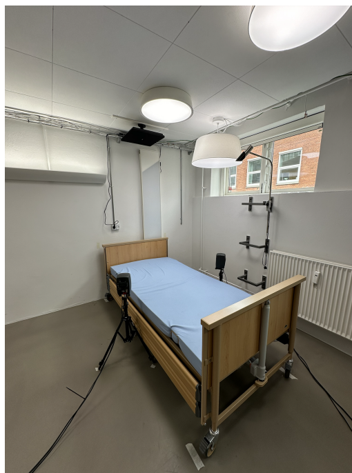
Figur 2.9: Et nærmere billede af forsøgsopstillingen for kondition 2, 4 og 6, dvs. under den retningsbestemte højtalerløsning, som er monteret i loftet over sengen.
