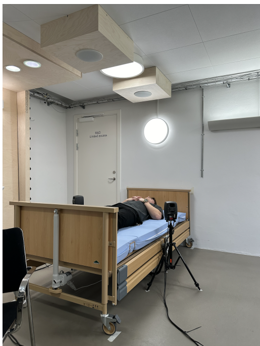
Figur 2.8: Et nærmere billede af forsøgsopstillingen for kondition 3, 5 og 7, dvs. under den nuværende højtalerløsning, som er monteret i loftet over sengen.
