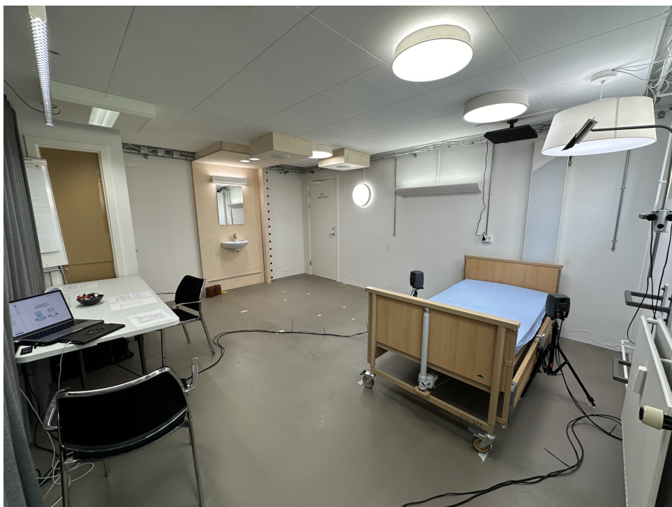
Figur 2.7: Et billede af forsøgsopstillingen (foruden bordet), der anvendes under lyttesessionerne. I dette tilfælde er sengen placeret under den retningsbestemte højttaler (kondition 2, 4 og 6), så derfor ville den senere skulle flyttes til venstre under den nuværende højttalerløsning (kondition 3, 5 og 7)
