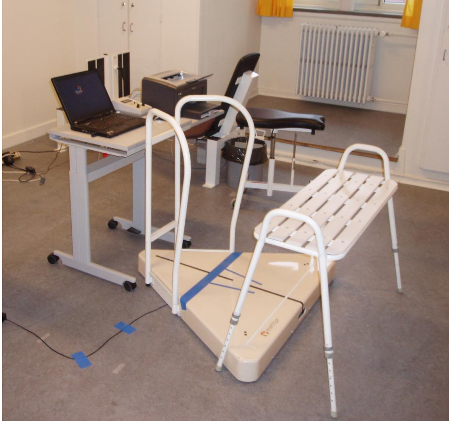
Figur 12. Forsøgsopstilling til balancetestene udført på kraftplatformen
