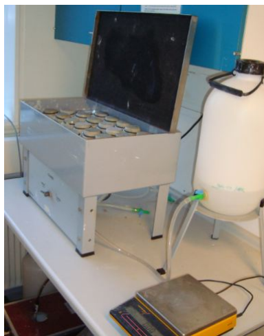
Figur 4.4: Retentionsboksen, hvor nyt vandindhold opnås.
