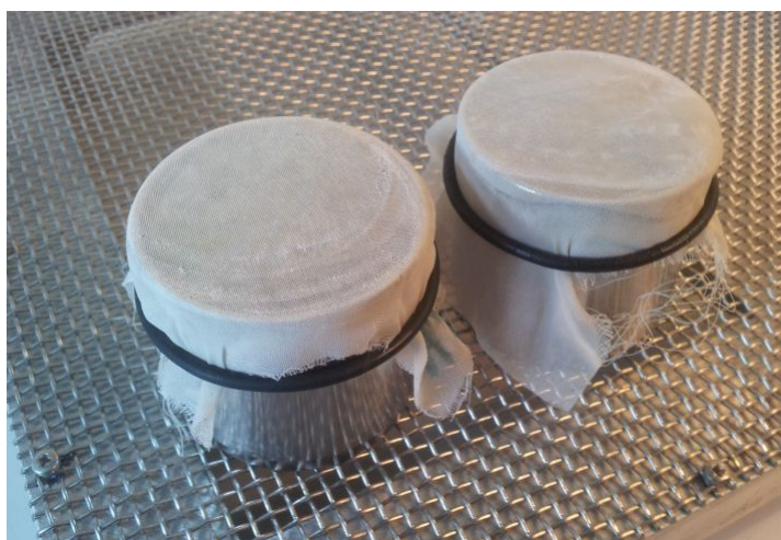
Figur 4.5: Intaktprøver, der drænes i atmosfærisk luft.
