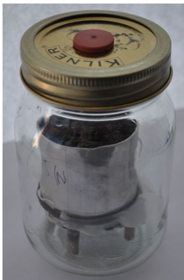
Figur 4.3: Opstilling for bestemmelse af flux fra intaktprøver.
