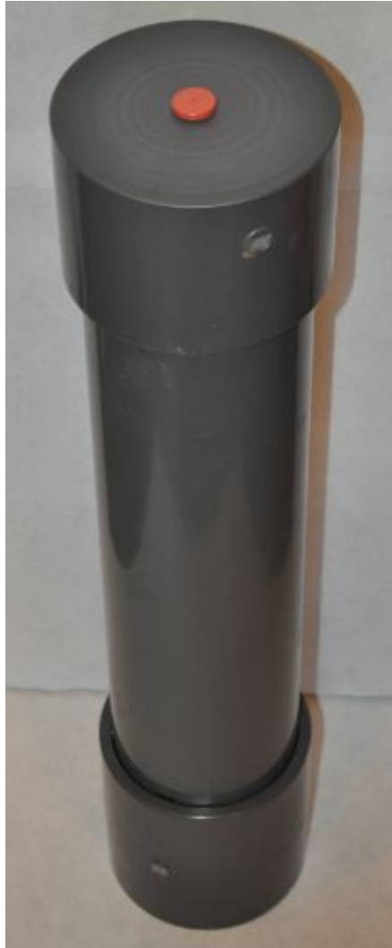
Figur 4.1: Opstilling til bestemmelse af flux ud fra hel søjle.
