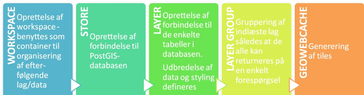
Figur 32: Opsætning af GeoServer trin for trin
