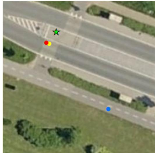
**Figur 43:** Testpunkt 2 - Positionsbestemmelsen vha. Locate-funktion afviger fra referencepunktet med 35m
