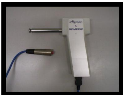
Figur 5.4.2, illustration af trykalgometeret, som er af type II fra Somedic Production AB med dertilhørende stopknap. Probe størrelsen er på 1\text{cm}^2
