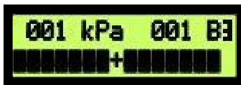
Figur 5.4.3, displayet på algometeret. Nederst på displayet iagttages skalaen for trykstigning. Hvis plusmarkøren er i midten, følger testlederen den rigtige progression i trykpåvirkningen. Øverst fra venstre ses det aktuelle tryk angivet i kPa. Under måling stiger værdien i takt med, at testlederen intensiverer trykpåvirkningen, i bestræbelserne på at følge trykstigningsskalaen. Når forsøgspersonen trykker på stopknap aflæses kraftpåvirkningsværdien på displayet. Placeret i øverste højre side er målingsnummer. Ved siden af er placeret probestørrelsen, som er angivet ved bogstavet B ( 1\text{cm}^2 ). Tallet efter probeangivelsen er "slope", hvor 3 betyder en trykpåvirkning på 30\text{kPa/s} .
