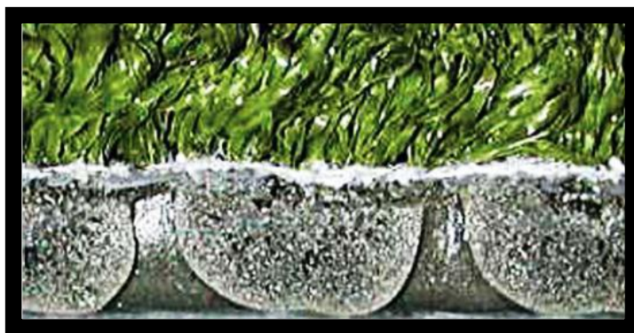
Figur 11.4.11 illustrerer kunstgræsunderlaget som blev brugt i forbindelse med hockeyturneringen ved OL Montreal 1976. Længden på fibrene er 10 - 12 mm, med et stødabsorberende lag af sand forneden [Artificial Grass for Sport Guide 2012].
