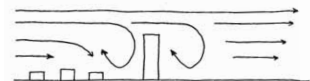
Stor variation i bygningsvolumener og specielt høje bygninger skaber turbulens
