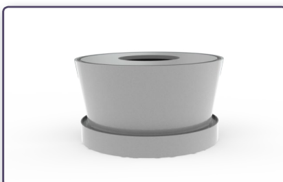
Fig 81 - Beholder med en vinkel på 100 grader og lige fod
