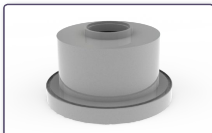
Fig 78 - Beholder radius 7,5 cm og højde 7,5 cm. Fod radius 9,5 cm og højde 2,5 cm
