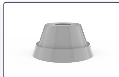
Fig 85 - Beholder med en vinkel på 70 grader og fod med en vinkel på 70 grader
