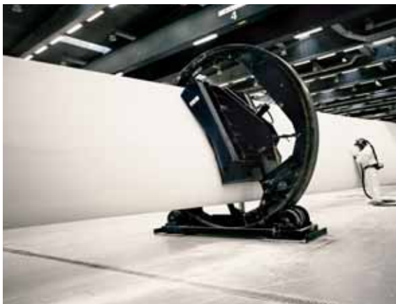
Kombinationen af træ/kulfiber-epoxykonceptet og Vestas' geometriske profiler har et betydeligt potentiale for design og produktion af omkostningseffektive vinger.
