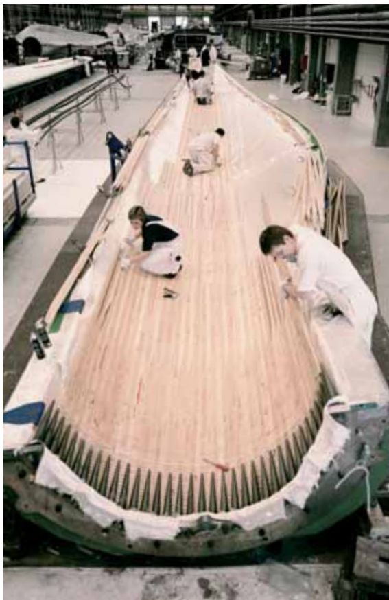
Kombinationen af træ/kulfiber-epoxykonceptet og Vestas' geometriske profiler har et betydeligt potentiale for design og produktion af omkostningseffektive vinger.
