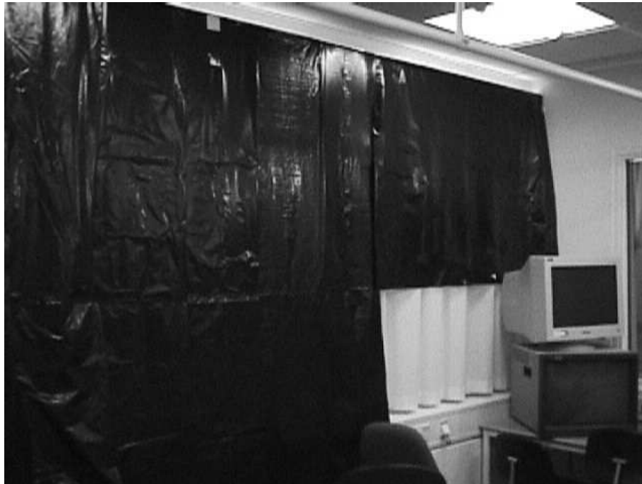
Figur 21 Affaldssække, der opføres i vindue vinduernes spejlglasser eller i testrum
