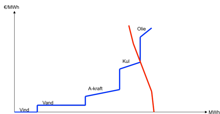
Figur 2.2: Udbud- og efterspørgselskurve for elektricitet på et generelt marked for en time
