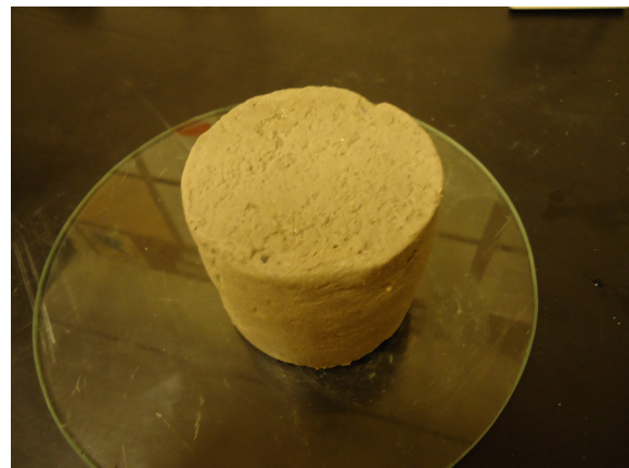
Figur 5.3 Efter tildannelse af prøve for kalkstabiliseret aalborgler med en kalkmængde på 4%
