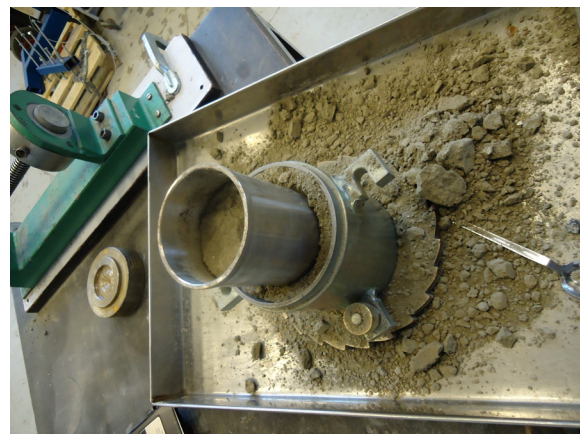
Figur 4.3 Prøveudtagelsesmetoden for kalkstabiliseret ler.
