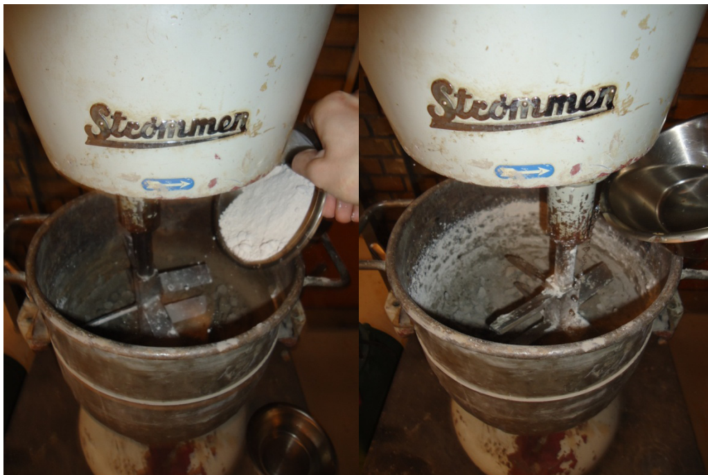
Figur A-1. Tilføjelse af kalk til venstre og efterfølgende tilføjelse af vand til højre under kalkstabilisering.
