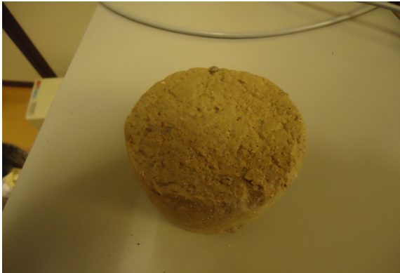
Figur 5.4 Den kalkstabiliseret prøve efter endt triaxial forsøg.
