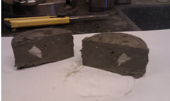
Figur 4.10 Intakt Aalborg ler, efter endt konsolideringsforsøg.
