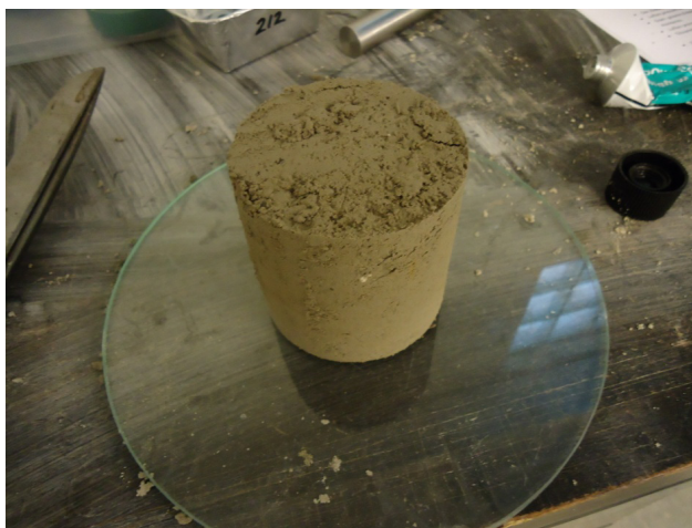
Figur C-1 Færdig tildannelse af kalkstabiliseret aalborglerprøve med 4 % kalk.
