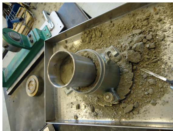
Figur 4.3 Prøvedannelse af kalkstabiliseret aalborgler. Prøven tages ud af proctorcylinderen.
