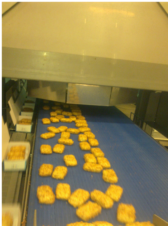
Figur 2.7: Pakkede kasser ses på transportbåndet til venstre, som har retning mod bunden af billedet og emnerne ses til højre på visiontransportbåndet med modsat retning [OCTOMATION, 2011].
