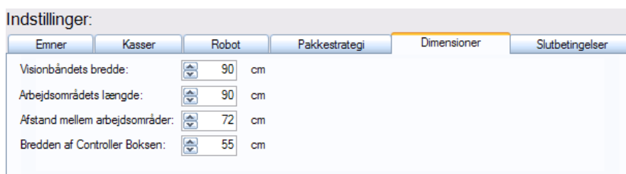
Figur 4.10: Under Dimensioner kan enkelte dimensioner for anlægget indstilles.
