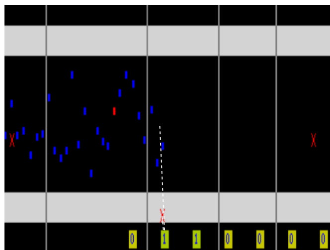
Figur 5.7: End-effectoren har lige afsat emnet i kassen og er på vej til næste emne. End-effectoren rammer emne og kasse præcist, tegn på at procestid og ruteplanlægning regnes korrekt ud.
