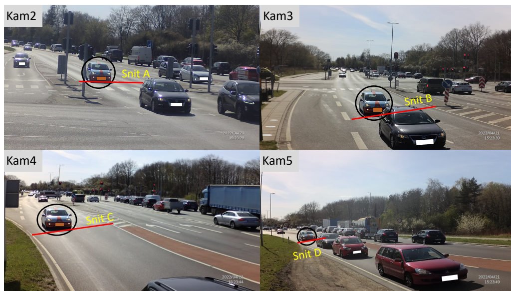
Figur 2.4: Synkronisering af videokameraerne gør det muligt at følge den enkelte trafikants færden gennem de fire målesnit. Billederne stammer fra optagelserne der er foretaget i krydset Klausdalsbrovej/Motorringvej 4 den 21. april 2022.
