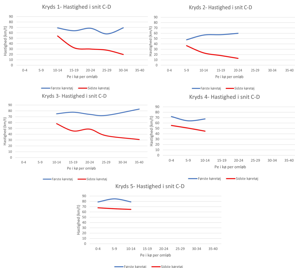
Figur 5.6: Beregnede hastigheds-flow relationer i kilestrækningen for det første og sidste registrerede køretøj i hver køsituation.
