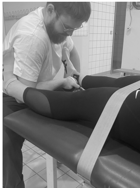
Figur 5: Placering af håndhold dynamometer ved måling af isometrisk muskelstyrke og rate of force development i hoftens adduktorer.
