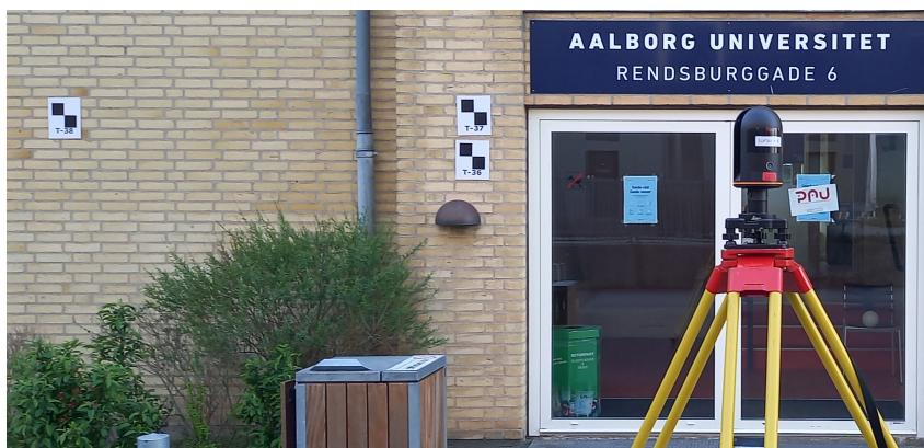
*Figur 8.2 Opmåling med BLK360 på fodstykke med plane targets i baggrunden*
