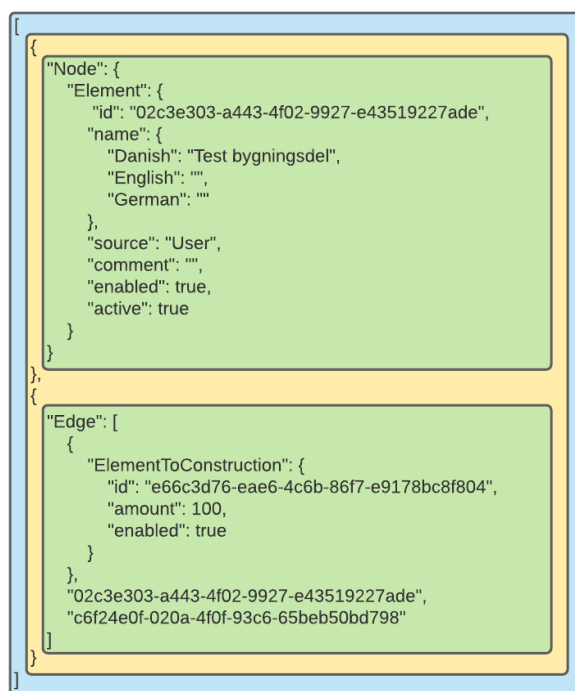
Figur 6.7 - Eksempel på elements.json filen hvor lists (blå), dictionaries (gul) og nodes og edges (grøn) er repræsenteret med farver.
