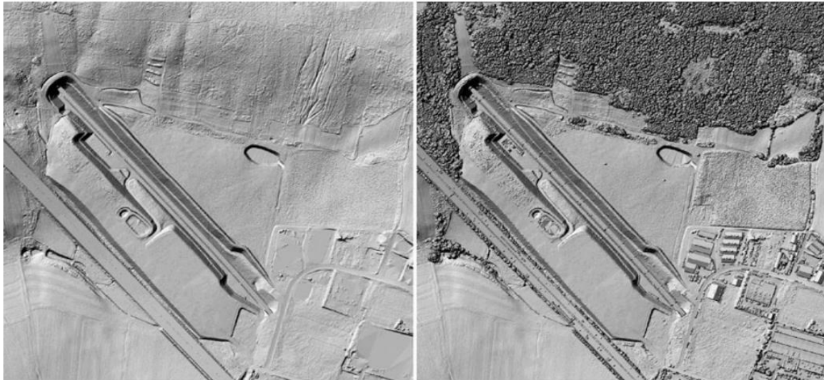
Figur 10: Digital Terræn model (DTM) og Digital Overflade Model (DSM) til højre (Hirt, 2014)
