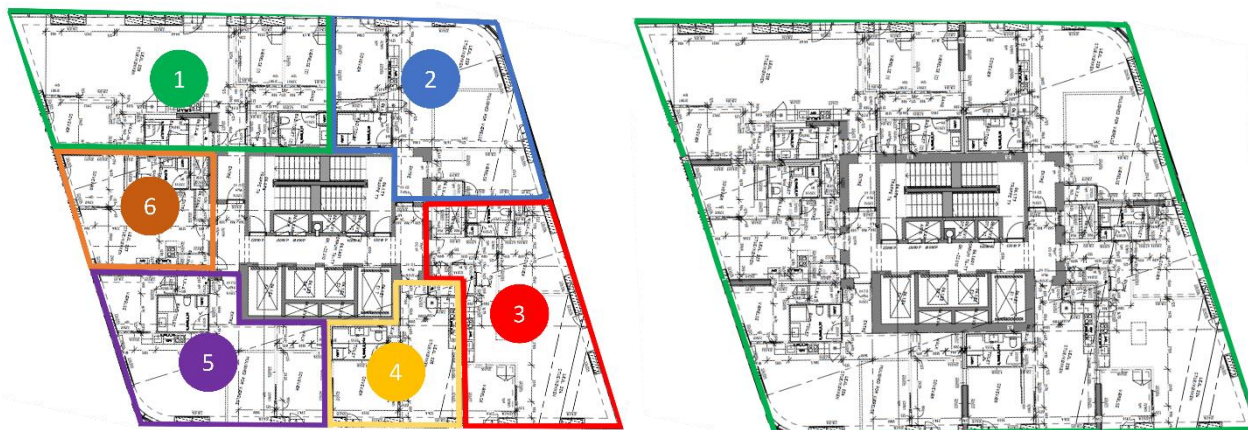
Figur 06: Illustration af skærestationer, på underlag af en arbejdstegning. OBS: Roteret, se evt. bilag 05.
