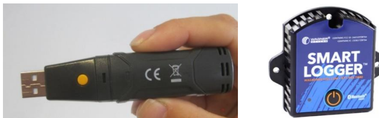
Figur 41 Billede af forprogrammeret USB-datalogger samt Bluetooth Smart-logger. (Eget billede USB-logger samt billede af smart-logger fra (38) www.fugtmaalere.dk ).
