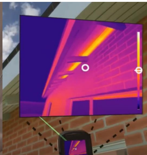
Billede 8.9: Bygningstermografering – Udvendig utæthed
