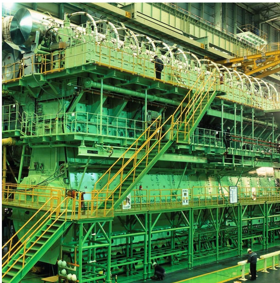
Billede 2 Wärtsilä Schulzer 14 cylindret motor på et moderne containerskib. (Kilde: Wärtsilä Corp, 2020)
