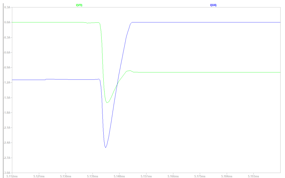
Figur 9.4.3: Simulering af strømmene, trukket af MOSFET'erne, i driveren.
