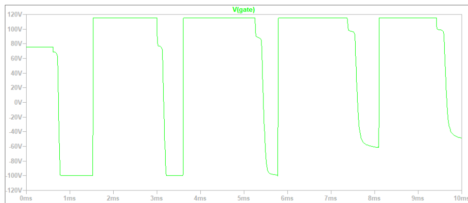
Figur 7.8.13: Udgangsspændingen efter Gate driveren.
