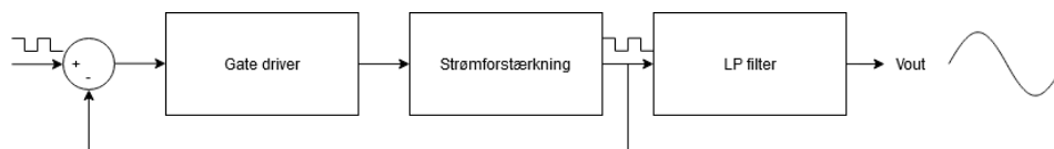
Figur 5.1.5: Blokdiagram der viser hvordan negativ PWM tilbagekobling kan laves.
