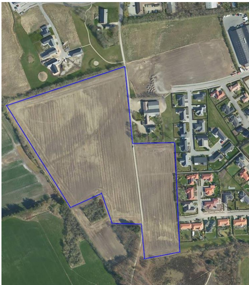
Figur 13: Område indenfor hvilket der er anlagt drænledninger.
