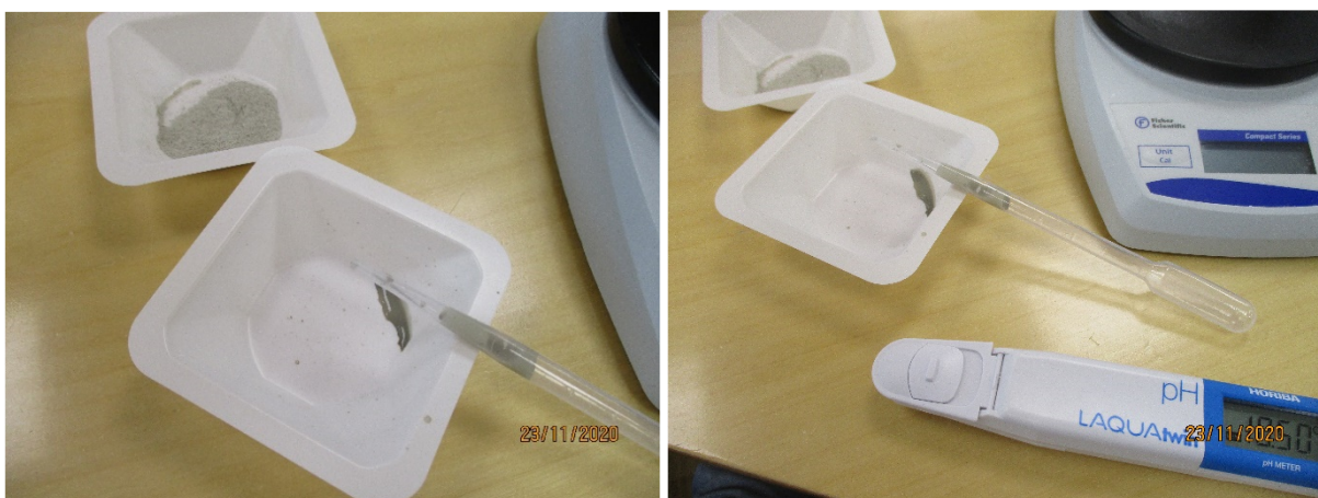
Figur 25, Repræsentative fotos fra pH-målinger udført på afmålte doser af deioniseret vand og betonstøv.
