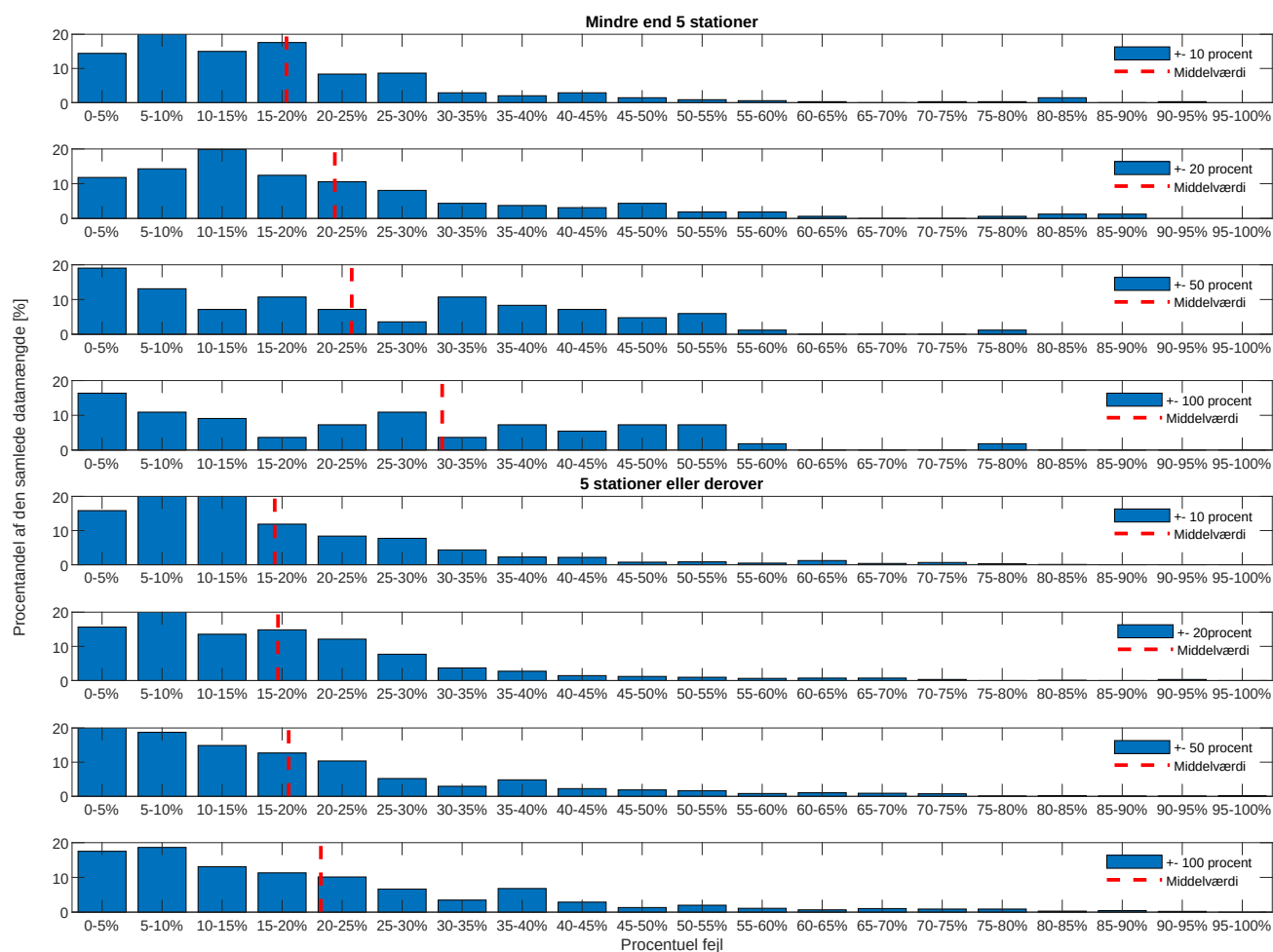
Figur H.5: Andelen af den totale datamængde hvor den procentuelle afvigelse mellem døgnsummer for den gennemsnitlige regnserie og den nærmeste SVK station i vinterperioden. Resultatet af analysen for < 5 Netatmo stationer og \geq 5 Netatmo stationer er ligeledes præsenteret.
