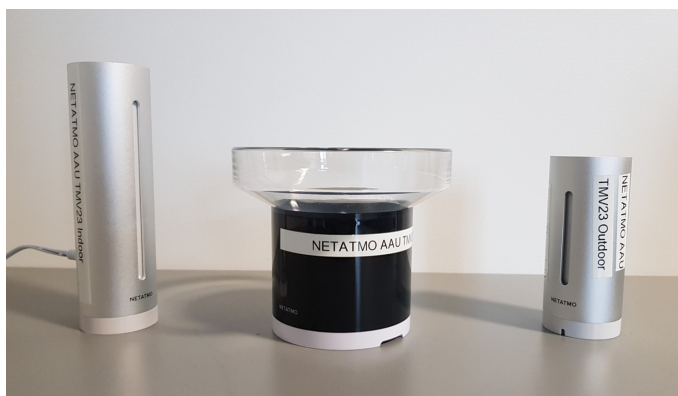
Figur 3.1: Netatmo station med indendørsmodul placeret til venstre, udendørsmodul placeret til højre og regnmåler placeret i midten.
