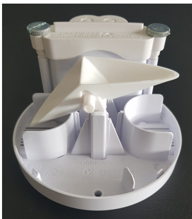
Figur 3.2: Vippekarsystemet i Netatmo regnmåleren.
