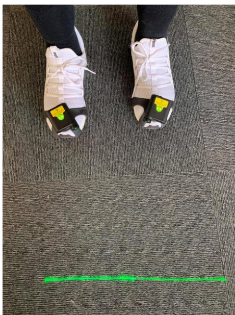
Billede 5: Path Finder påsat sko med projektering af laserlys
