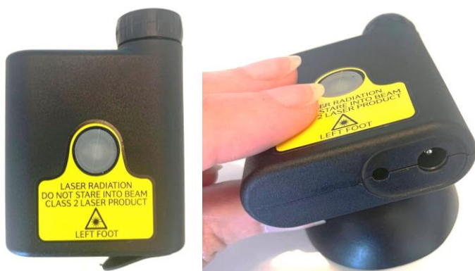
Billede 4: Laser enheden ses for oven med tænd/sluk knap samt indgangen til batteriopladeren.
