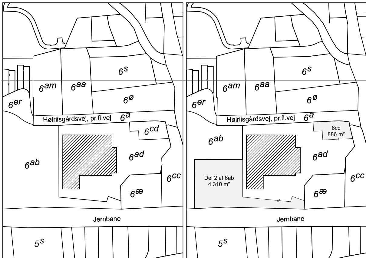
Figur 5.4: Skitse af de matrikulære ændringer i sagen U2018-60311. Der bliver foretaget en arealoverførsel fra matr.nr. 6ab til matr.nr. 6ad samt en sammenlægning af matr.nr. 6cd med matr.nr. 6ad, alle Brabrand by, Brabrand. Desuden er en nu nedrevet fabriksbygning angivet på skitsen.
